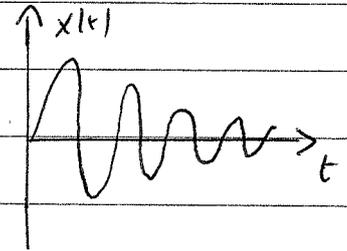
Insgesamfassung: Frequenz nimmt ab:  $\omega_0 \rightarrow \sqrt{\omega_0^2 - \delta^2}$
