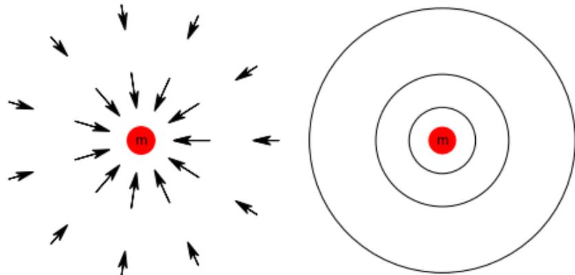
**Abb. 4.16** Beispiel einer Zentralkraft (links) und Äquipotentialflächen dazu (rechts).
