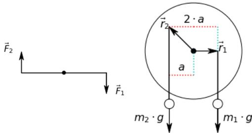
**Abb. 4.20** Links: Beispiel für ein Kräftegleichgewicht, aber kein Drehmomentgleichgewicht. Rechts: Drehscheibe mit Gewichten und Drehmomenten.
