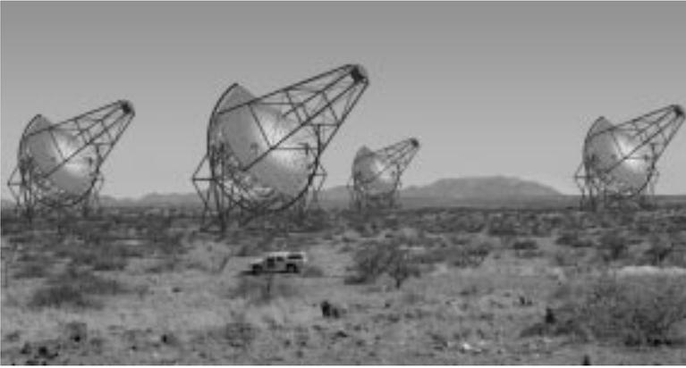
**Abbildung 9.1:** Fotomontage der ersten Ausbauphase des H.E.S.S.-Observatoriums mit 4 Teleskopen im Khomas-Hochland auf einer Höhe von 1800 m über Meeressniveau in Namibia. Die 4 Teleskope mit einem jeweiligen Durchmesser von 11 m haben eine um das zehnfache gegenüber den HEGRA-Teleskopen vergrößerte Lichtsammelfläche. Die Nachweisschwelle sinkt entsprechend auf 50 GeV. In der zweiten Ausbauphase sind 16 Teleskope auf einer vergrößerten Grundfläche geplant.
