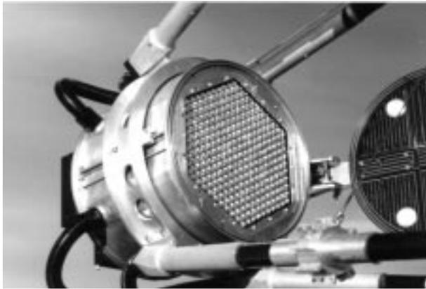
**Abbildung 3.3:** Die Fotografie zeigt die Kamera im Primärfokus mit geöffnetem Schutzdeckel. Die hexagonale Anordnung der Pixel ist deutlich zu erkennen.
