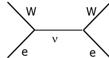
Entscheidender Punkt (ohne Rechnung): Masse des  $W$ :  $M_W > 0 \rightarrow$  Helizität 0 möglich, und dieser **"longitudinale" Anteil** steigt mit  $s$  an.
