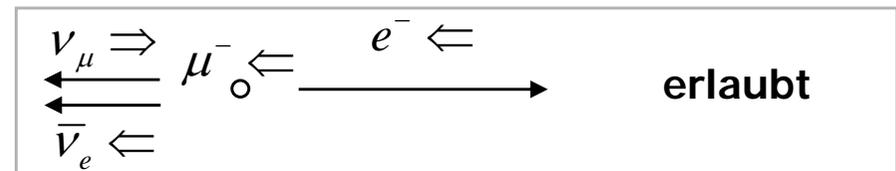
Polarisierte  $\mu^+$  aus Zerfall  $\pi^+ \rightarrow \mu^+ \nu$  (Polarisation  $P_\mu$ )  $\rightarrow$  Winkelverteilung  $dN(e^+)/d\cos(\theta) \sim 1 - P_\mu \cos(\theta)$
