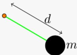
Das Trägheitsmoment eines Körpers bei Drehung um seine Symmetrieachse unterscheidet sich von dem bei Drehung um eine andere Achse.
