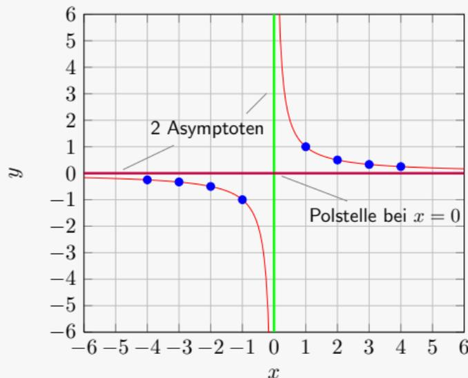
**Gesetz von Boyle-Mariotte** Gilt für abgeschlossene Gasmenge bei konstanter Temperatur  $T$  mit Volumen  $V$  und Druck  $P$
