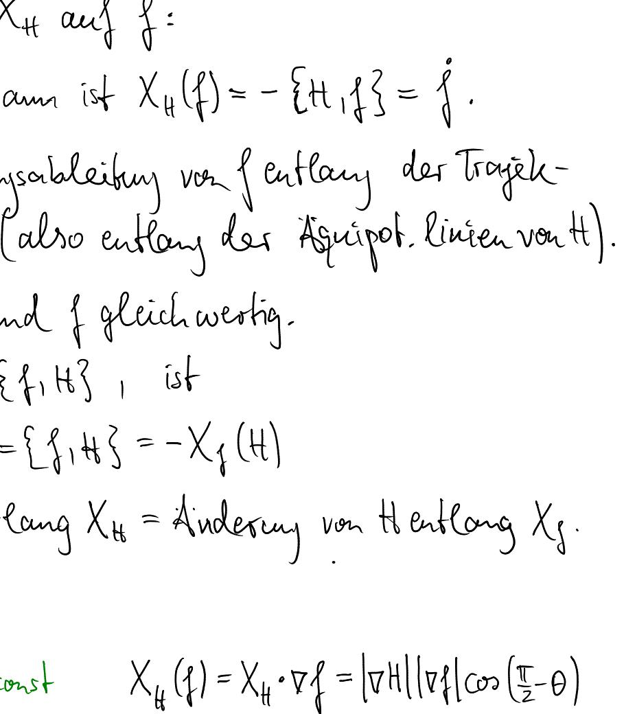
$\Rightarrow$  Die Equipotentiallinien sind die Trajektorien des Systems. (zumindest im 1d-Fall wie im Bild. Wenn  $\dim(M) = 2n > 2$ , dann liegen die Trajektorien auf den Equipotential-Hyperflächen (mit codimension 1) von  $H$ ).
