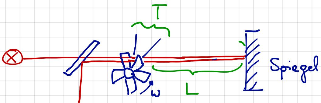
Bestimme Drehzahl, bei der zurückgespiegeltes Licht gerade vollständig vom nächsten Zahn abgedeckt wird:
