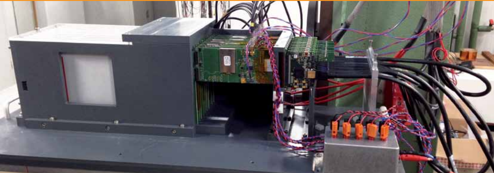
Der komplette Detektoraufbau des Prototypen im Testbeam. Der kleine silberne Kasten rechts unten sorgt für die innovative Stromversorgung.
