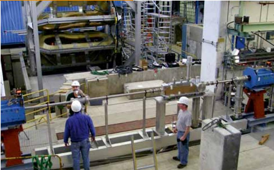
Die Targetzelle (vorne rechts) ist in den DORIS-Beschleuniger eingebaut. Im Hintergrund die Toroid-Magnetspule von OLYMPUS.
