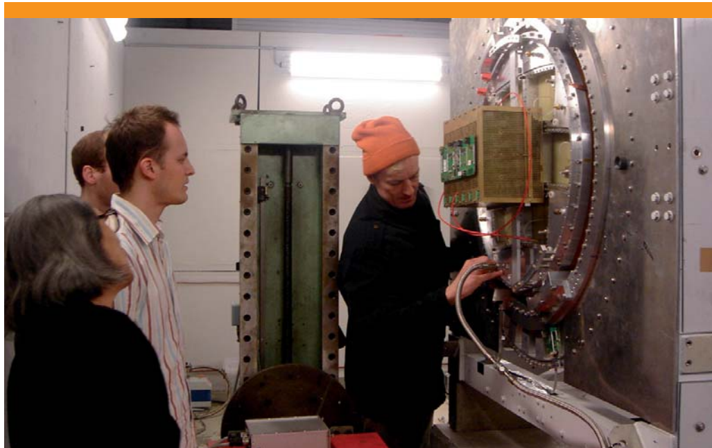
Einbau der Zeitprojektionskammer TPC in den Testmagneten
