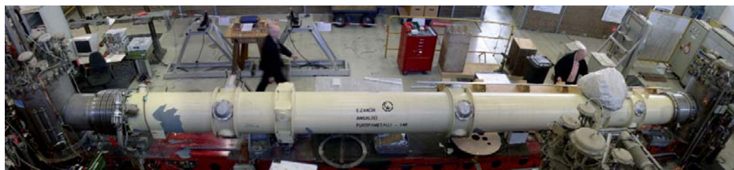
In Halle 55 ist ein HERA-Dipolmagnet schon voll funktionsfähig. Laser (Laser Zentrum Hannover) und Detektor (Hamburger Sternwarte, Universität Hamburg) machen ALPS bald komplett. Infos: http://alps.desy.de/
