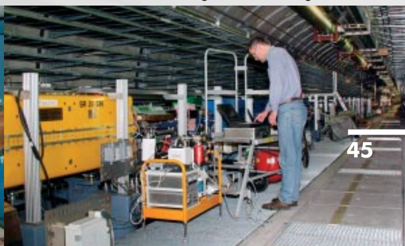
Umbau abgeschlossen: 25 m vor dem Kollisionspunkt verlaufen die Vakuumkammern für die Teilchenstrahlen bereits in gemeinsamen Magneten.
