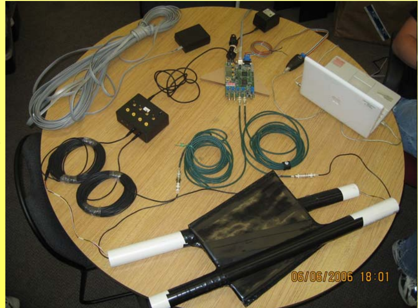
Der Versuchsaufbau bei der Arbeit mit dem Quarknet - Detektor
