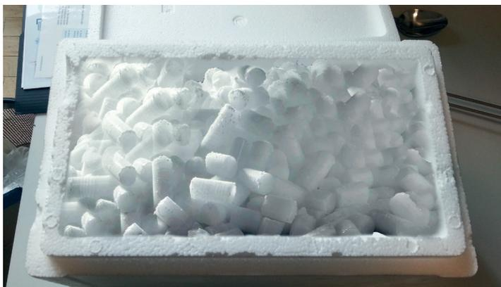
Abb. 3: Trockeneis in Pelletform
