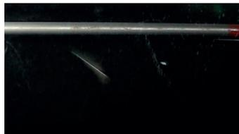
Abb. 21: Alpha-Teilchen ausgehend von Thoriumstab
