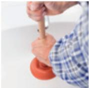
Wird bei der Abflussreinigung auf chemische Hilfsmittel verzichtet, kann ein „Pümpel“ verwendet werden. Auch zur Befestigung von Haken an der Wand werden kleine Saugnäpfe verwendet (Handtuchhalter). Die größeren Saugnäpfe dienen zur Halterung von Geräten auf der Arbeitsplatte. Eine weitere Anwendung ist der Saugheber, mit dem z. B. Glas- oder Steinplatten transportiert werden können.
