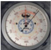
Segelflieger verwenden zur Bestimmung ihrer Flughöhe einen Höhenmesser. Dieses Instrument nutzt die Tatsache aus, dass der Luftdruck mit zunehmender Höhe abnimmt und funktioniert defacto wie ein Barometer.
