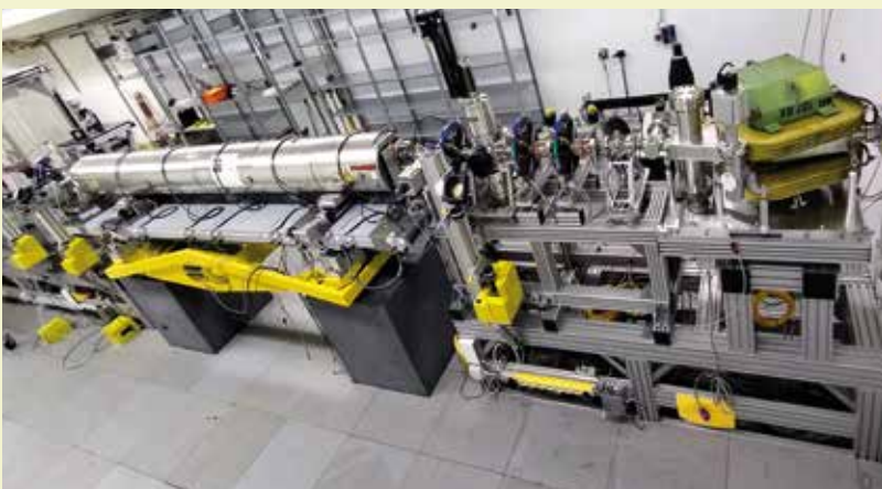
Blick in die PITZ-Erweiterung mit dem Terahertz-Laser. Der Undulator zur Erzeugung der Laserstrahlung ist auf dem gelben Gestell montiert, der Elektronenstrahl fliegt von rechts in die Strahlführung.
