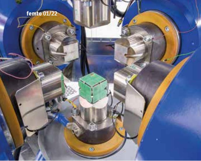
Die 4,5 Meter hohe und 35 Tonnen schwere Riesenstempelzelle kann auf jeder ihrer drei Achsen einen Druck von 500 Tonnen ausüben, das entspricht dem 300 000-fachen atmosphärischen Druck oder den Druckverhältnissen 900 Kilometer tief unter dem Erdboden. Dabei lassen sich die Proben mit dem hellen Röntgenlicht von PETRA III durchleuchten und geben so ihre innere Struktur preis.
