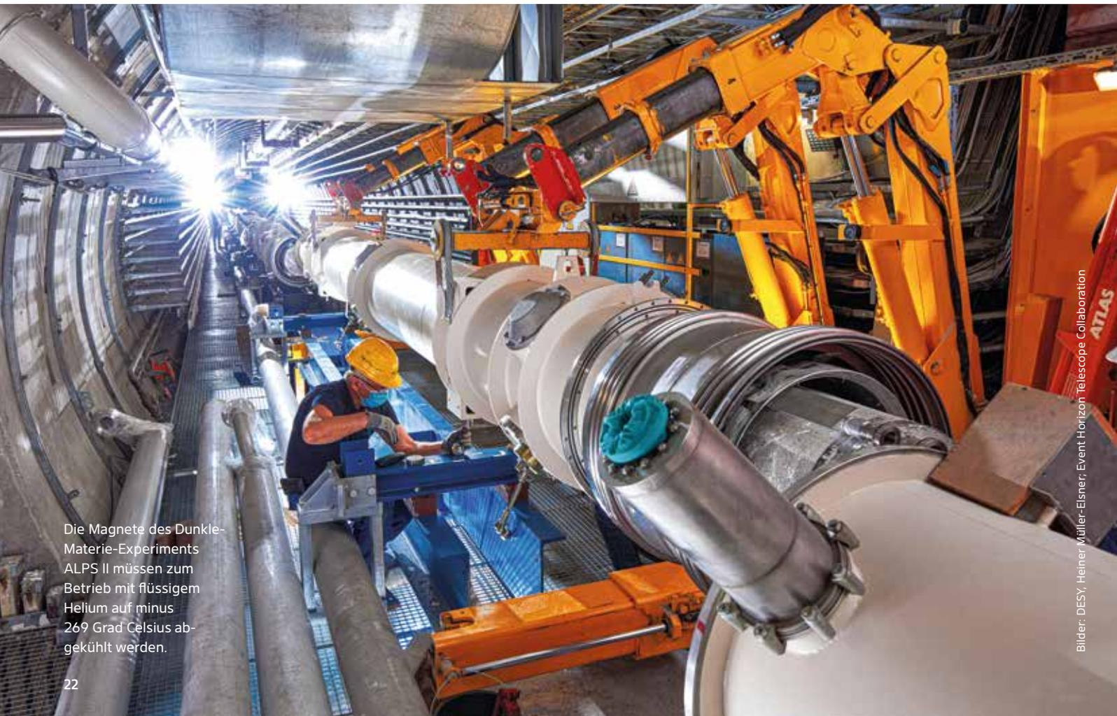
Die Magnete des Dunkle-Materie-Experiments ALPS II müssen zum Betrieb mit flüssigem Helium auf minus 269 Grad Celsius abgekühlt werden.
