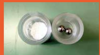
Reines mechanisches Mahlen von Gemischen aus Nukleinbasenpulvern mit Stahlkugeln führte nicht zu einer Bildung der gewünschten Guanin-Cytosin-Paare.
