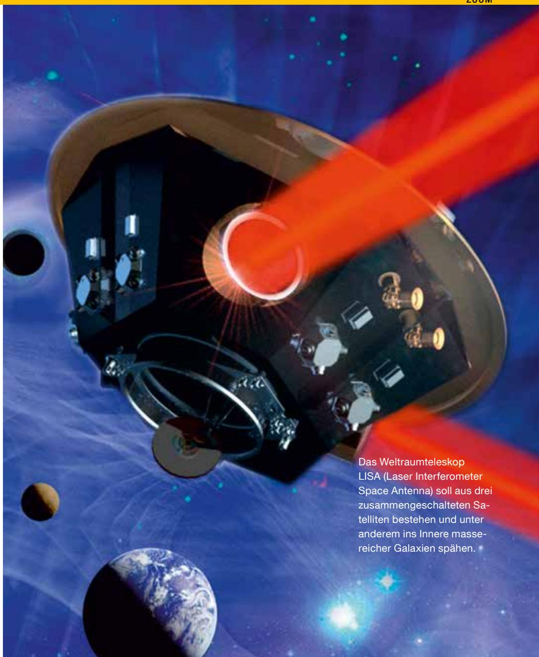
Das Weltraumteleskop LISA (Laser Interferometer Space Antenna) soll aus drei zusammengeschalteten Satelliten bestehen und unter anderem ins Innere massereicher Galaxien spähen.
