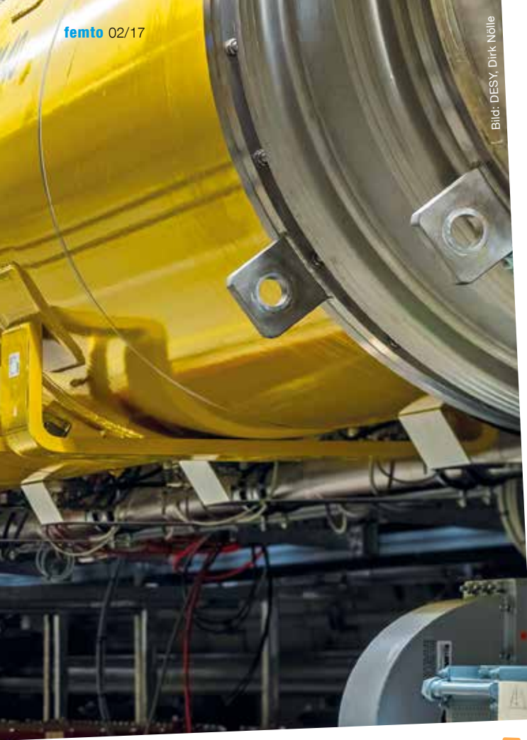
Der längste supraleitende Linearbeschleuniger der Welt treibt den europäischen Röntgenlaser European XFEL an.
