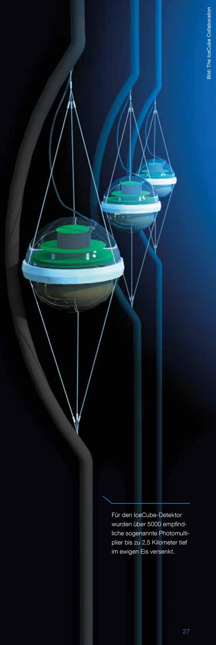
Für den IceCube-Detektor wurden über 5000 empfindliche sogenannte Photomultiplier bis zu 2,5 Kilometer tief im ewigen Eis versenkt.
