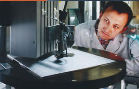
Das Niob (oben) wird mehrfach aufgeschmolzen (oben links) und die gewalzten Bleche genau vermessen (links).
