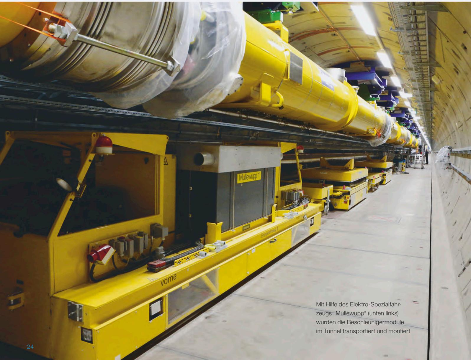
Mit Hilfe des Elektro-Spezialfahrzeugs „Mullewupp“ (unten links) wurden die Beschleunigermodule im Tunnel transportiert und montiert
