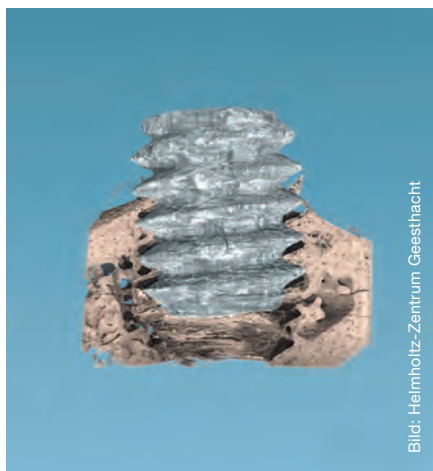
Dynamische Prozesse wie der Abbau einer Knochenschraube aus einer neuartigen Magnesiumlegierung lassen sich mit der Echtzeittomographie verfolgen.
