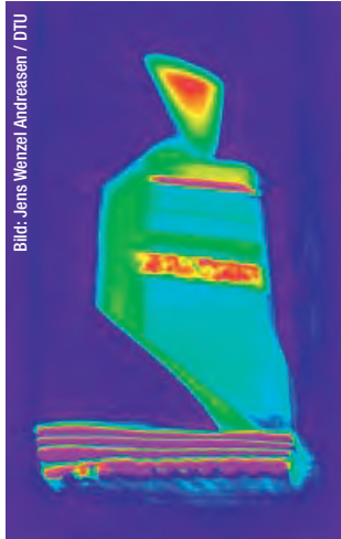
Ptychographische Phasen- kontrast-Projektion der Polymer- Tandemsolarzelle (zwei mal vier Mikrometer groß). Auf der Silberelektrode (breites rot-gelbes Band) liegt eine Schicht leitendes Polymer. Die beiden darüber liegen- den Solarzellen (hellblau) werden von einer dünnen Zinkoxid-haltigen Schicht (grün) getrennt. Oberhalb der zweiten Solarzelle ist die zweite Elektrode zu sehen (rot). Das Dreieck darüber ist der Rest einer Wolfram-Nadel, mit der die Probe unter dem Rasterelektronen- mikroskop präpariert wurde.
