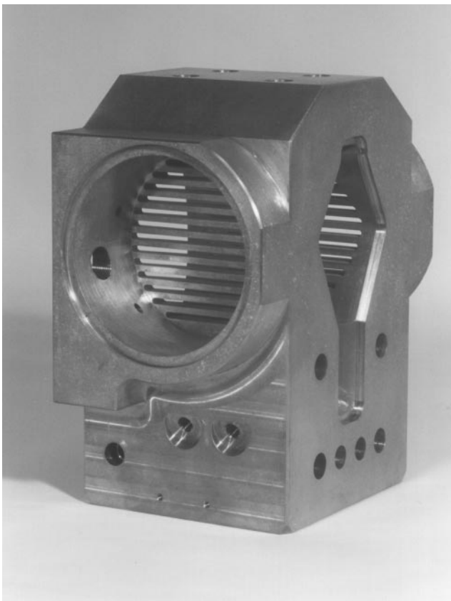
Abbildung 104: Absorbergehäuse für die HERA-Luminositätserhöhung.
