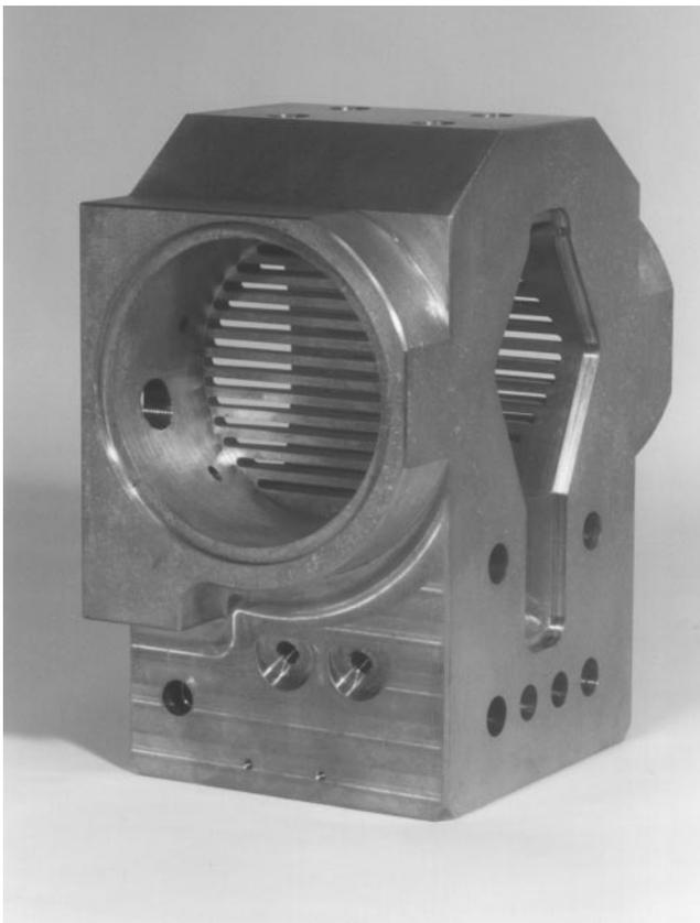
Abbildung 104: Absorbergehäuse für die HERA-Luminositäts­erhöhung.
