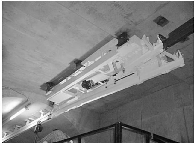
Abbildung 112: Weiche für die Schwebebahn im TTF/FEL-Tunnel.
