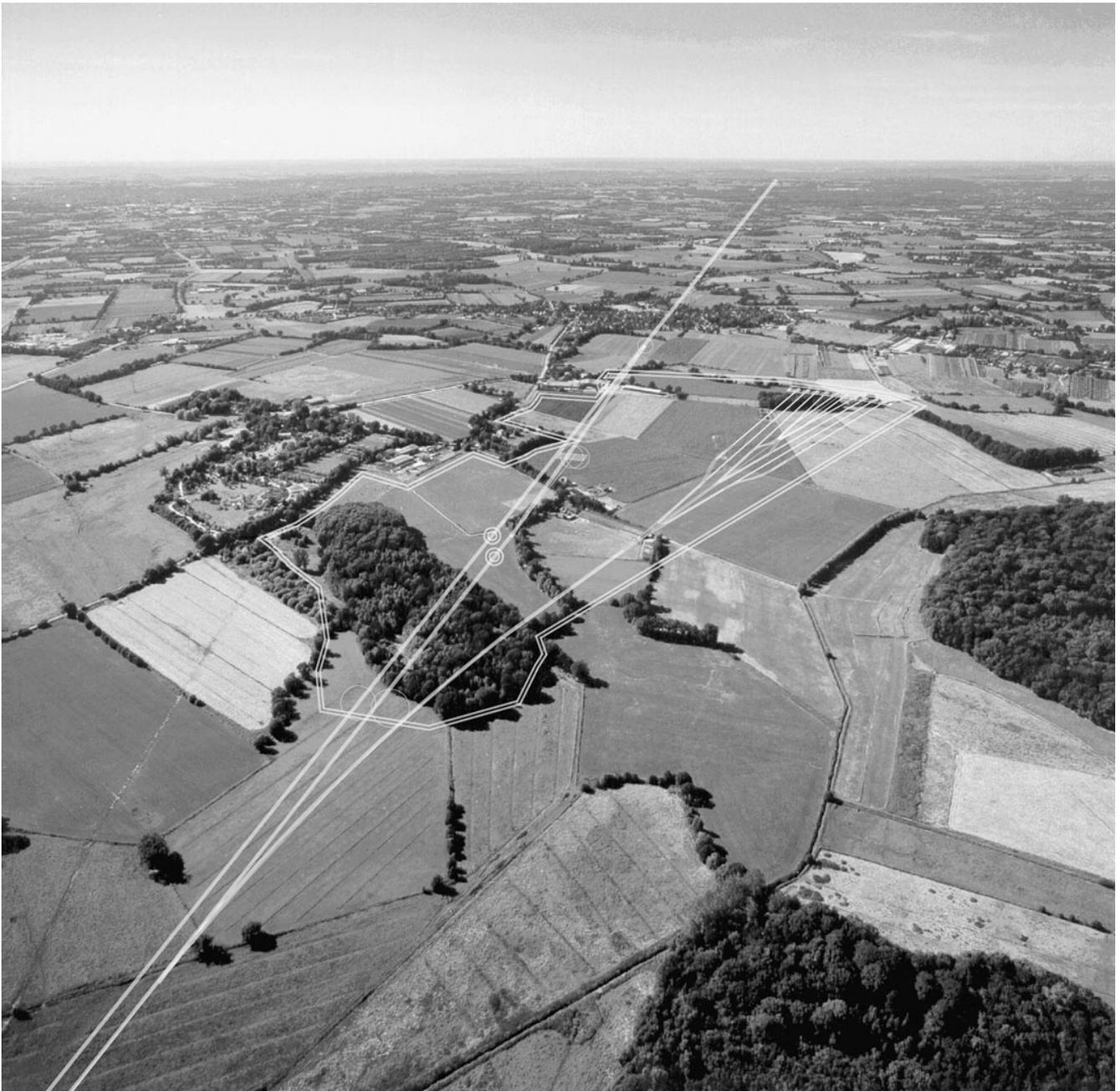
Abbildung 110: Geplante Trassenführung und Lage des FEL-Fächers im Bereich Ellerhoop.
