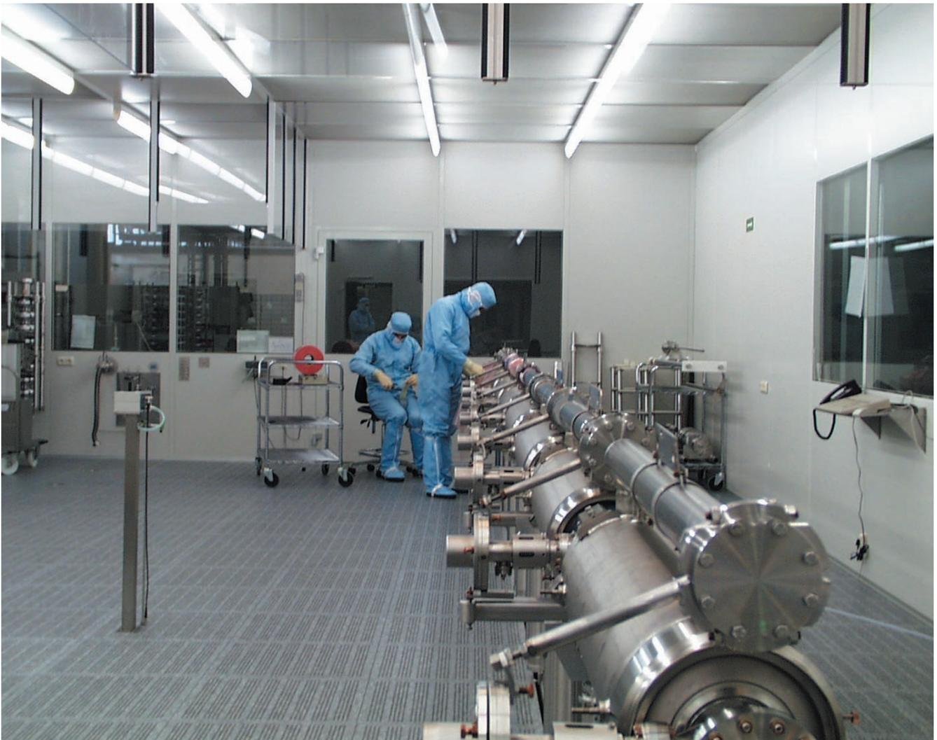
Abbildung 88: Modul 3 zur Vorbereitung des integralen Lecktests.
