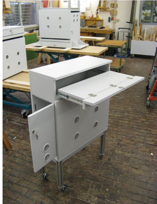
Abbildung 112: Computerschrank für Visualisierungssystem der PETRA-III-Warnanlage.
