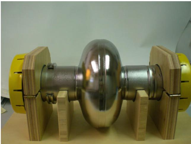
Abbildung 88: Patent erteilt: Verfahren zur Herstellung von Einkristall-Halbzellen aus Niob für die Fertigung von supraleitenden Hochfrequenzresonatoren.
