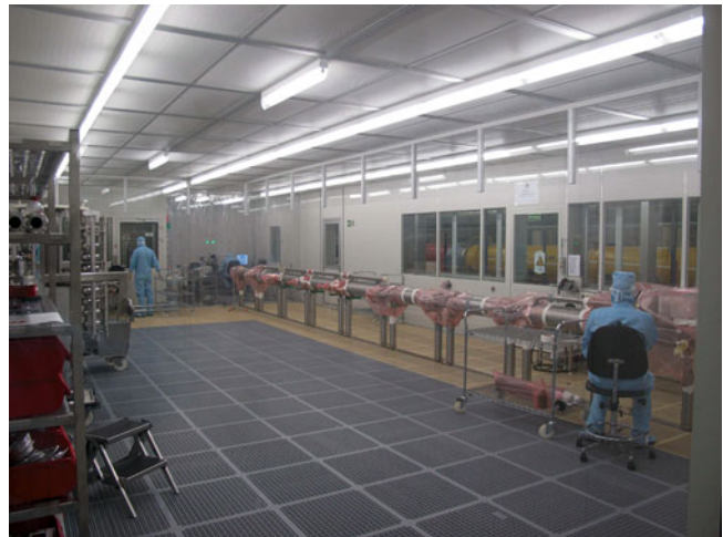
Abbildung 72: Ansicht des Kavitätsstrings für das Modul 3-3Stern im erweiterten Arbeitsbereiches ISO 4 im Arbeitsbereich 1 (Gelbe Bodenplatten = Klasse ISO 4 Bereich; Graue Bodenplatten = ISO 5 Bereich).
