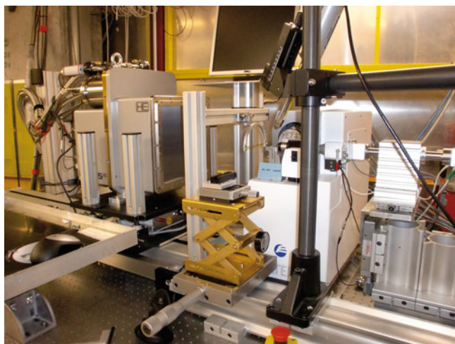
Abbildung 22: MD2-Diffraktometer und RAYONIX 225HE CDD Detektor wie im Testaufbau an BW7A (DORIS III) eingebaut.
