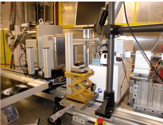
Abbildung 22: MD2-Diffraktometer und RAYONIX 225HE CDD Detektor wie im Testaufbau an BW7A (DORIS III) eingebaut.
