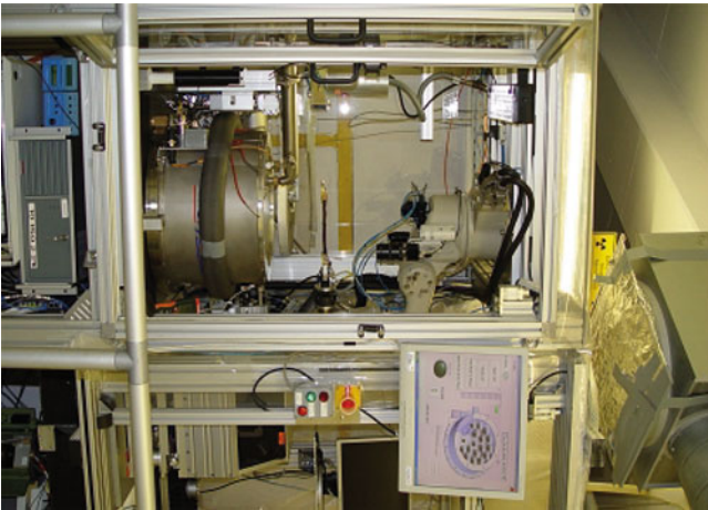
Abbildung 21: MARVIN Probenwechselroboter für Proteinkristallographie an Strahlführung BW7b.
