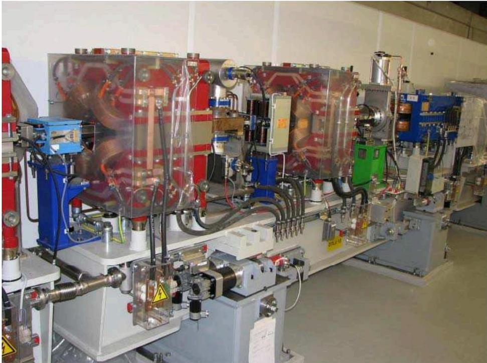
Abbildung 138: *Installierter Girder DTLU im neuen Achtel.*
