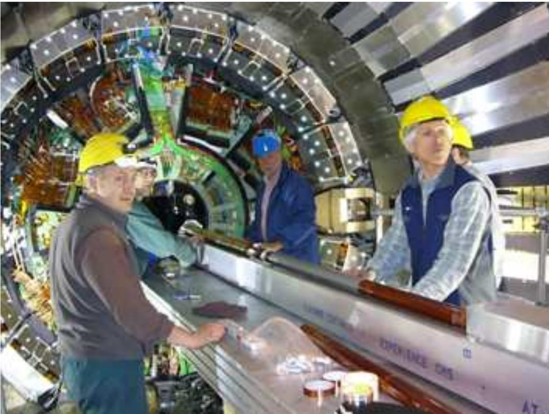
Abbildung 59: *Einbau des zentralen Strahlrohres.*
