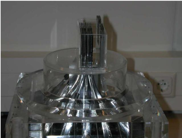
Abbildung 3: Ein ALFA Prototyp in einer Plexiglas-Nachbildung des Roman Pots.
