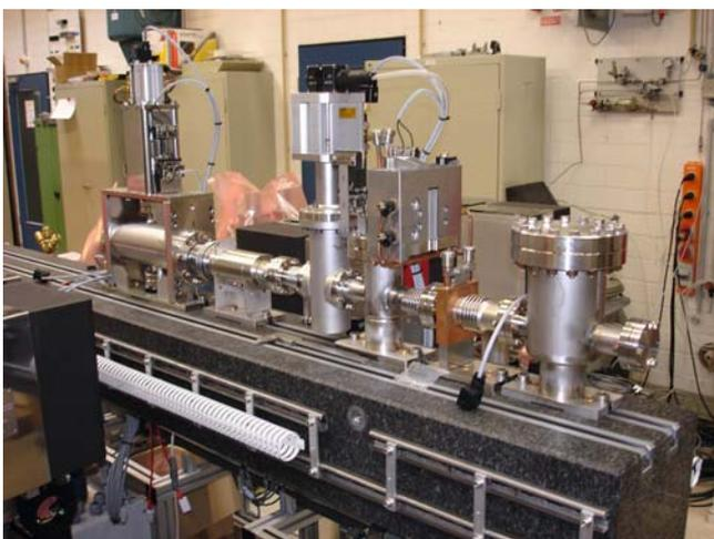
Abbildung 189: 1. Granitstein der Frontend-Beamline PETRA III mit (v. r. n. l.): Pumpkopf, Absorber und Schnellschlussklappe (ZM31).
