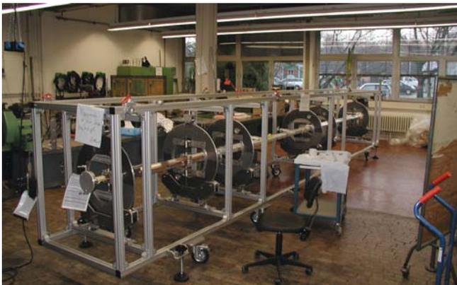
Abbildung 192: Überlange Auslasskammer in der Schweiß- und Prüfvorrichtung, PETRA III (ZM31).
