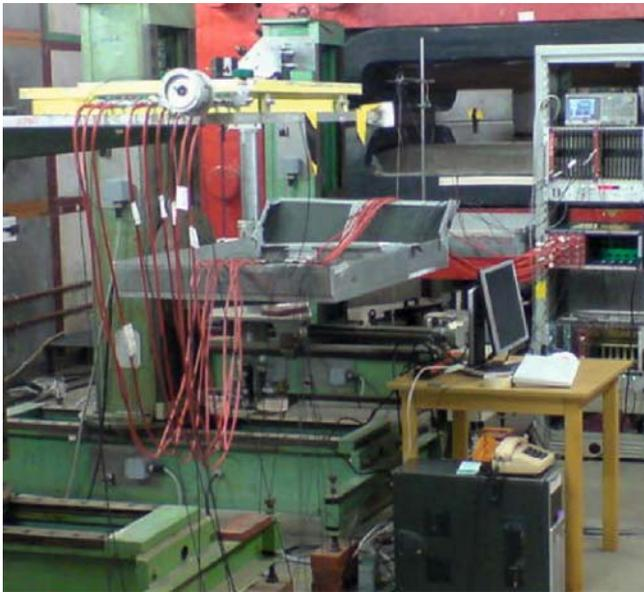
Abbildung 101: Teststrahllaufbau mit dem Cherenkov-Detektor des SLD-Polarimeters.
