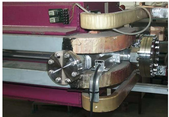
Abbildung 152: Dipolkammern für die Alten Achtel. Oben Rohlinge; unten eingebaute Kammer.
