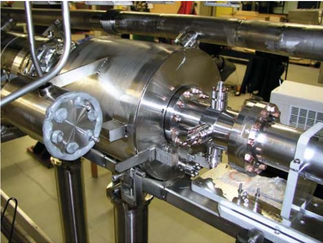
Abbildung 160: Prototyp des supraleitenden XFEL-Magneten mit Strahllagemonitor nach Montage im Reinraum.
