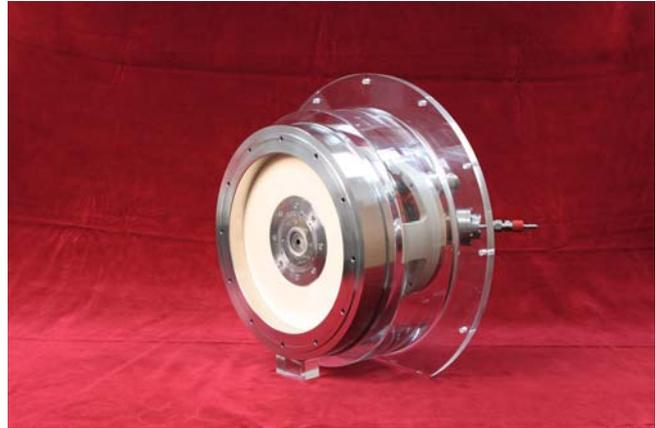
Abbildung 146: Die neue HERA HF Multicusp  $H^-$ -Ionen Quelle mit vollisolierter Plasmakammer und Aufhängung in einer Keramikscheibe.
