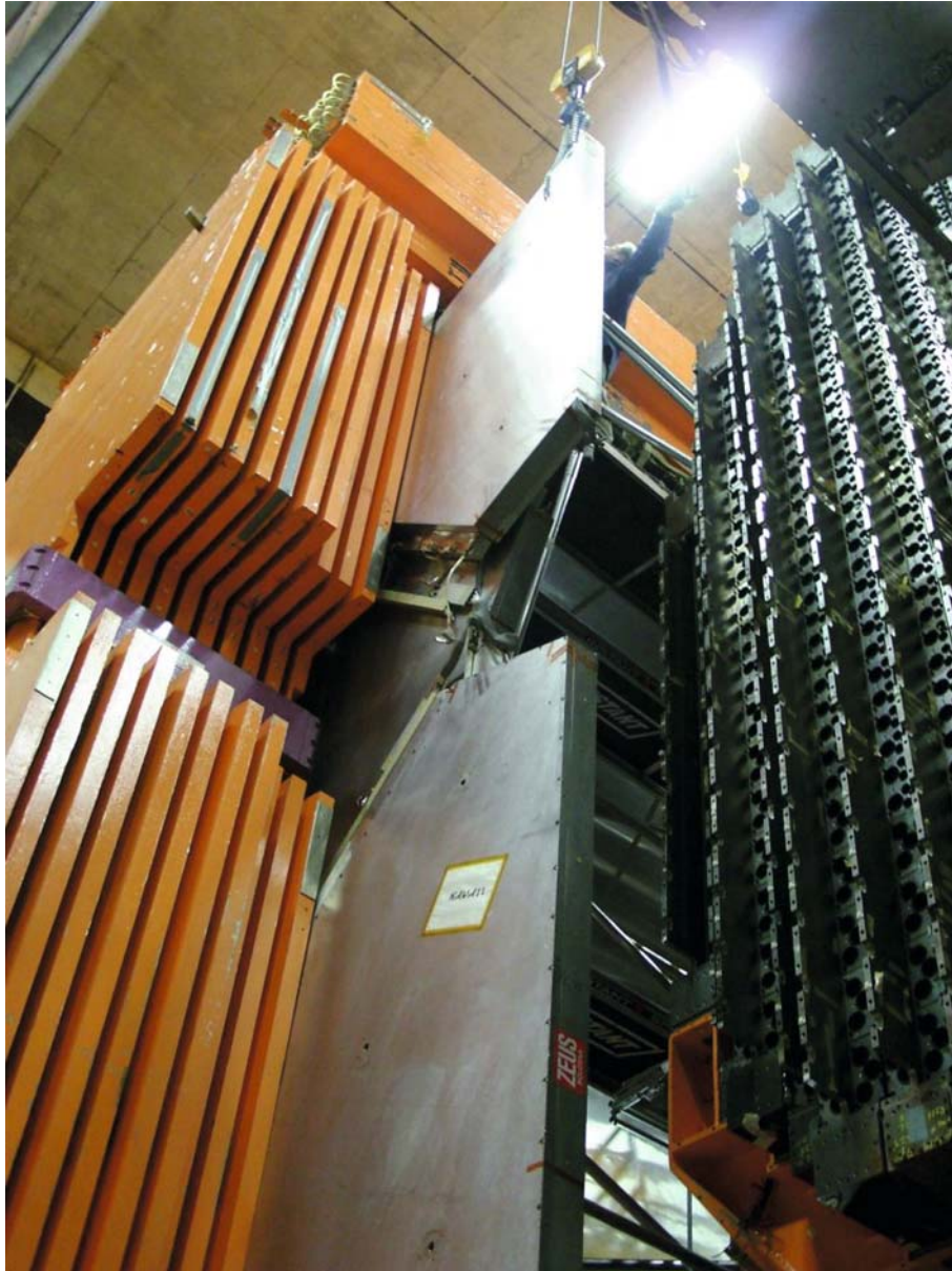
Abbildung 36: Der Vorwärtsbereich des ZEUS Detektors während des Ausbaus einer der großen inneren Myonkammern. Links im Bild orange erkennt man das Eisenjoch und im rechten Teil die Rückseite des Vorwärtskalorimeters, aus dem bereits die Photoröhren entfernt wurden.
