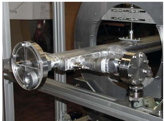
Abbildung 191: Schweißkonstruktion Laserauslasskammer, PETRA III (ZM31).
