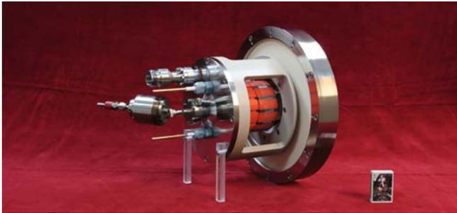
Abbildung 195: Kegelzylinder-Teilchenkonverter für die Hochfrequenz  $H^-$ -Quelle (ZM32).
