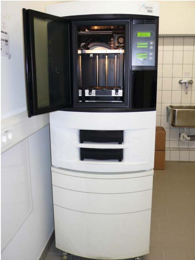
Abbildung 187: Rapid Prototyping Anlage vom Typ Dimension SST (ZM1).
