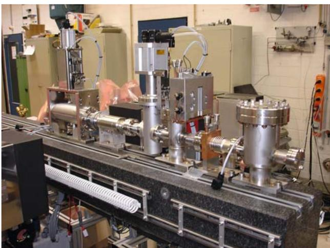
Abbildung 189: 1. Granitstein der Frontend-Beamline PETRA III mit (v. r. n. l.): Pumppopf, Absorber und Schnellschlussklappe (ZM31).
