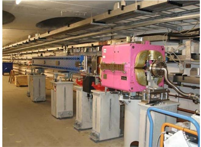
Abbildung 153: Testaufbau einer Wigglerstrecke im PETRA Tunnel.
