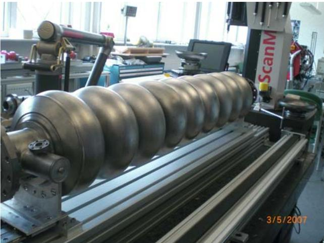
Abbildung 166: Der erste 9-zellige durch Hydroforming gebaute Resonator.
