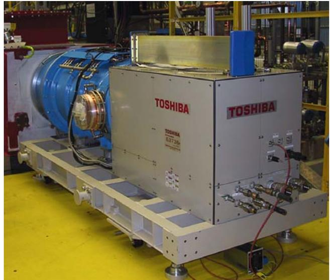
Abbildung 148: *Horizontales Multibeam-Klystron während der Installation im Teststand bei DESY.*
