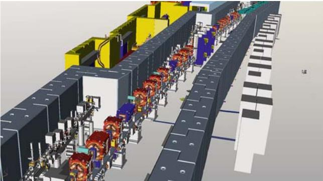
Abbildung 170: Ausschnitt aus dem Beschleunigerkomplex PETRA III im 3D CAD-Modell.
