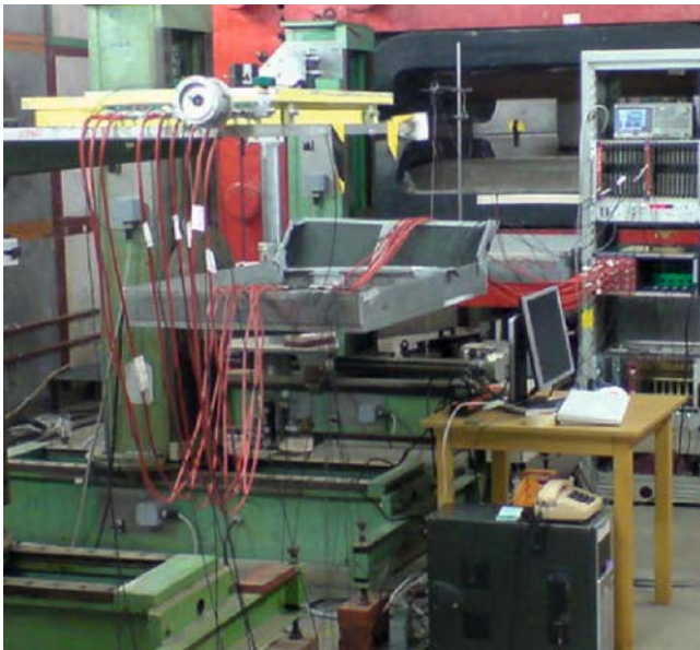
Abbildung 101: Teststrahllaufbau mit dem Cherenkov-Detektor des SLD-Polarimeters.
