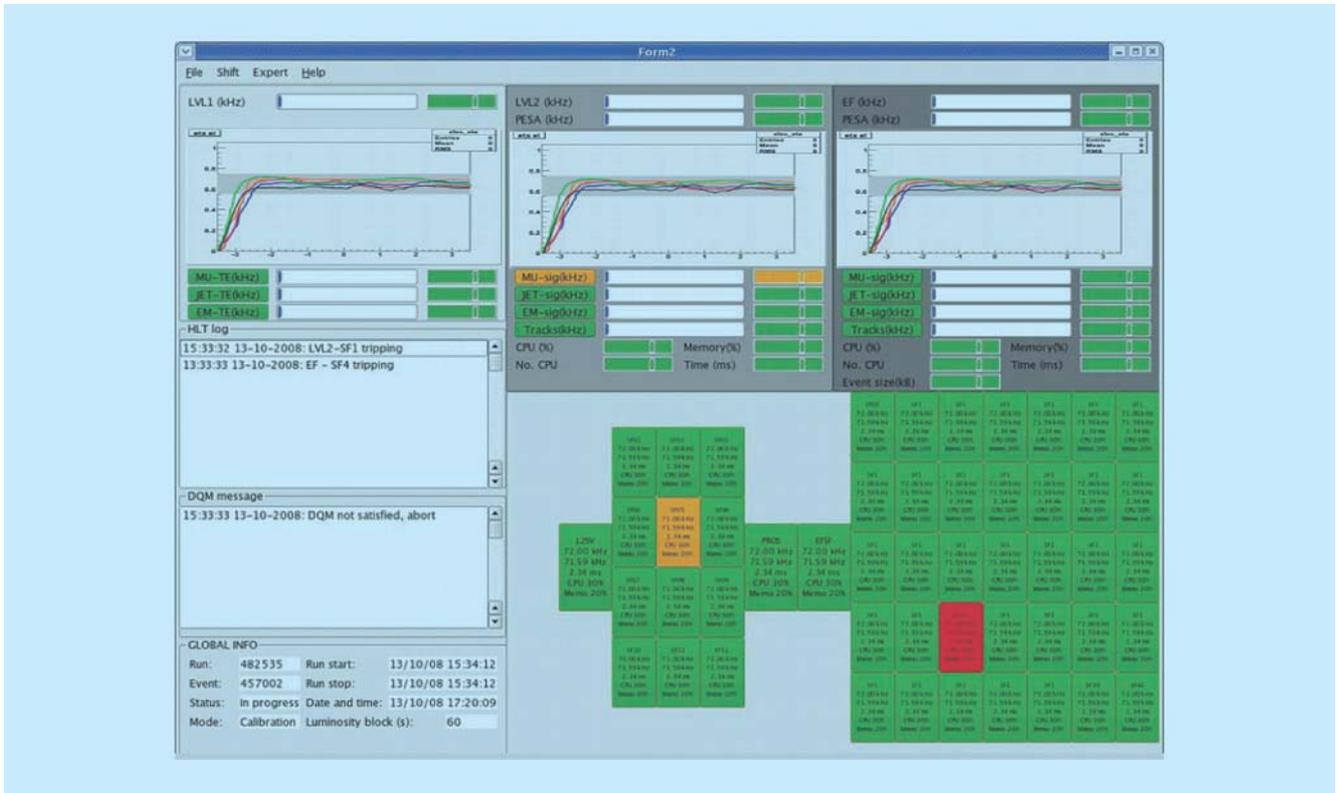
Abbildung 53: Vorgeschlagene Benutzeroberfläche für die Überwachung des Triggers.
