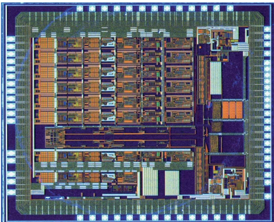
Abbildung 164: Auslesechip für den 7-zelligen Silizium Driftdetektor.
