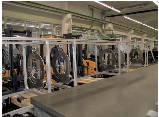
Abbildung 152: Dreh- und Schweißvorrichtung für überlange Vakuumkammern, PETRA III (ZM1/ZM31).
