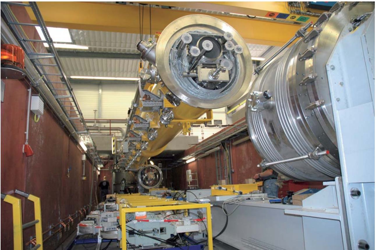
Abbildung 110: Das supraleitende Beschleunigermodul Nr. 6 auf dem im Herbst 2006 fertig gestellten Teststand in Gebäude 70.
