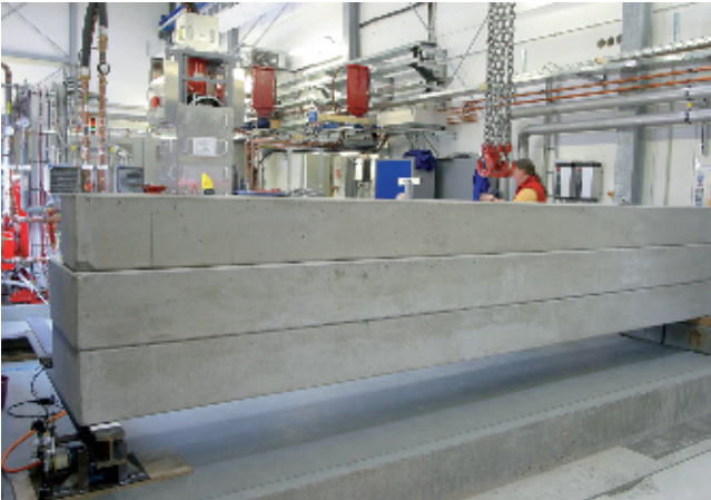
Abbildung 142: Schwerlasttest für die Justierplattform für XFEL-Undulatoren.
