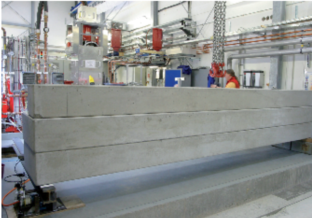
Abbildung 142: Schwerlasttest für die Justierplattform für XFEL-Undulatoren.
