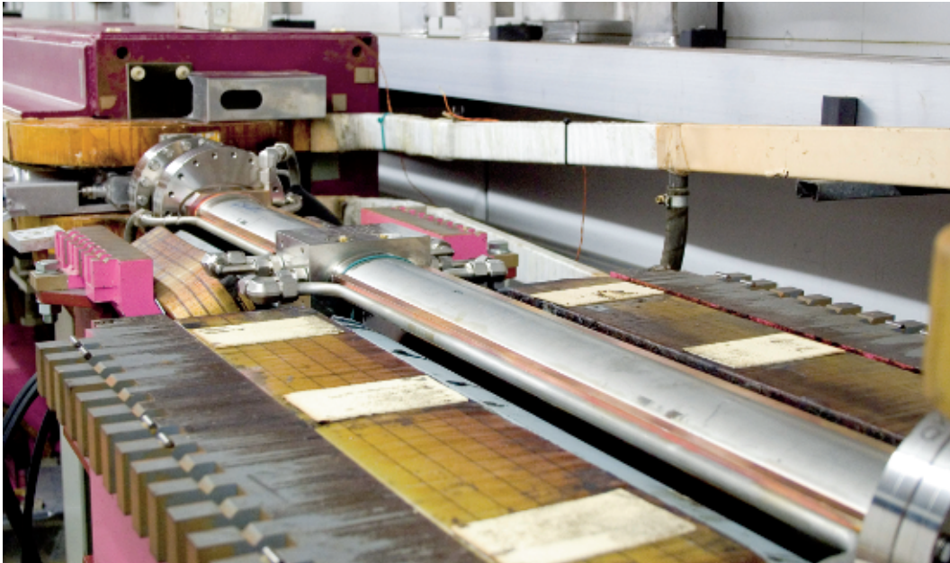
Abbildung 107: Systemtest für das neue Vakuumsystem in PETRA II. Abgebildet ist die eingebaute Vakuumkammer aus elliptischem Edelstahlprofil in den noch geöffneten Quadrupol- und Sextupolmagneten.
