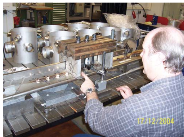
Abbildung 146: Entwicklung einer speziellen Ausbeul-Vorrichtung für die Reparatur einer Vakuumkammer, HERA (ZM31).
